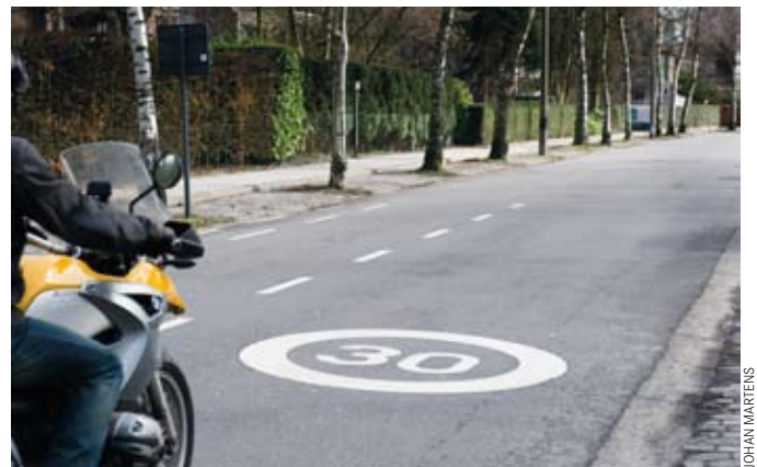
Wegmarkeringen over de volledige breedte van de rijbaan worden afgeraden omdat motorrijders er bij nat weer gemakkelijk op slippen. Het is beter om een vrije doorgang te voorzien van min. 50 cm.
