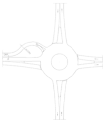
fig. 4.25.1 Principeschets tweerichtingsfietspad langs aanvoerweg – rotonde met gemengd verkeer
