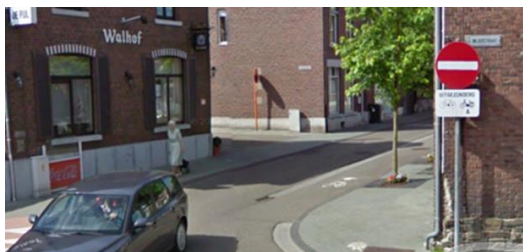
Foto 4.66 Autoverkeer en fietsverkeer in tegenrichting worden van elkaar gescheiden door een goot
