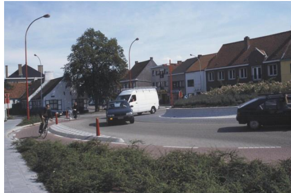
Foto 4.37 Rotonde in overgangsgedied met (deels) vrijliggend fietspad met fietsers in de voorrang - Brugge
