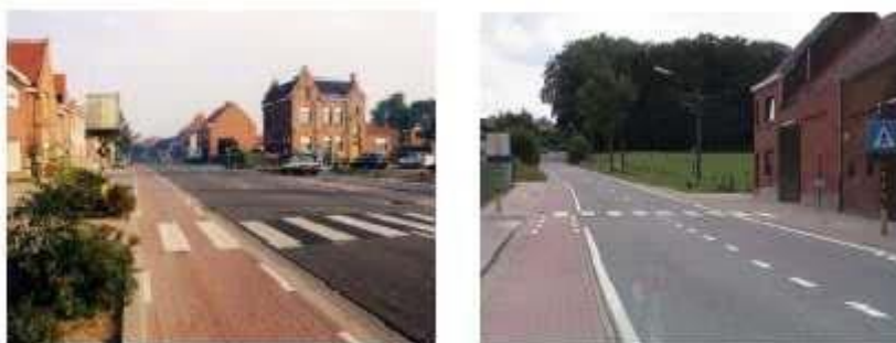
Fig. 4.63 Wegmarkeringen voetgangersoversteek versus fietspad
