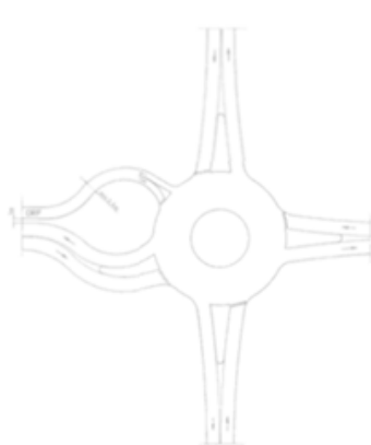
fig. 4.25.2 Principeschets tweerichtingsfietspad langs uitbuigende aanvoerweg – rotonde met gemengd verkeer
